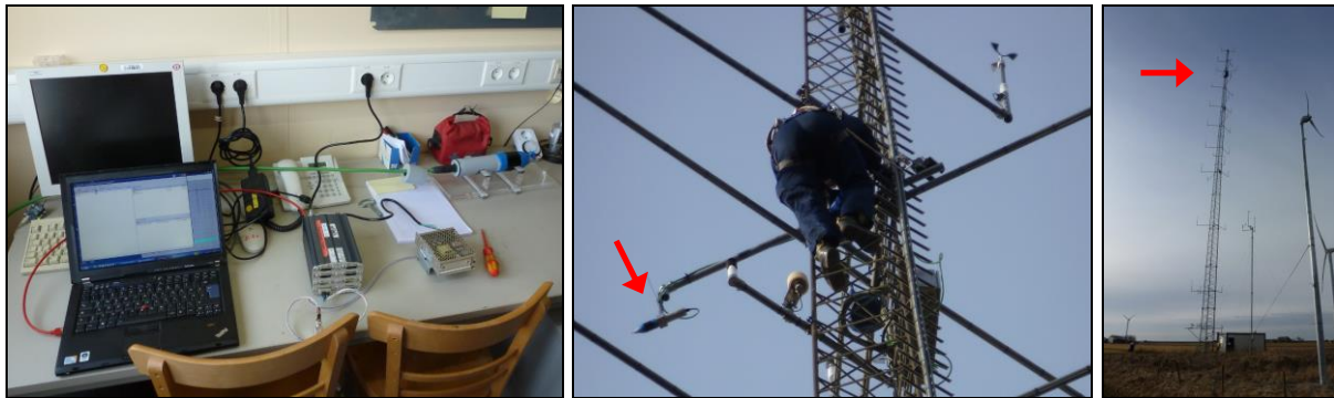
Abbildung 2: Werkbanktest des LCA (links), Installation auf dem Onshore-Messmast (mitte), Lage des LCA auf dem Messmast (rechts). Das LCA wird durch den roten Pfeil markiert.
