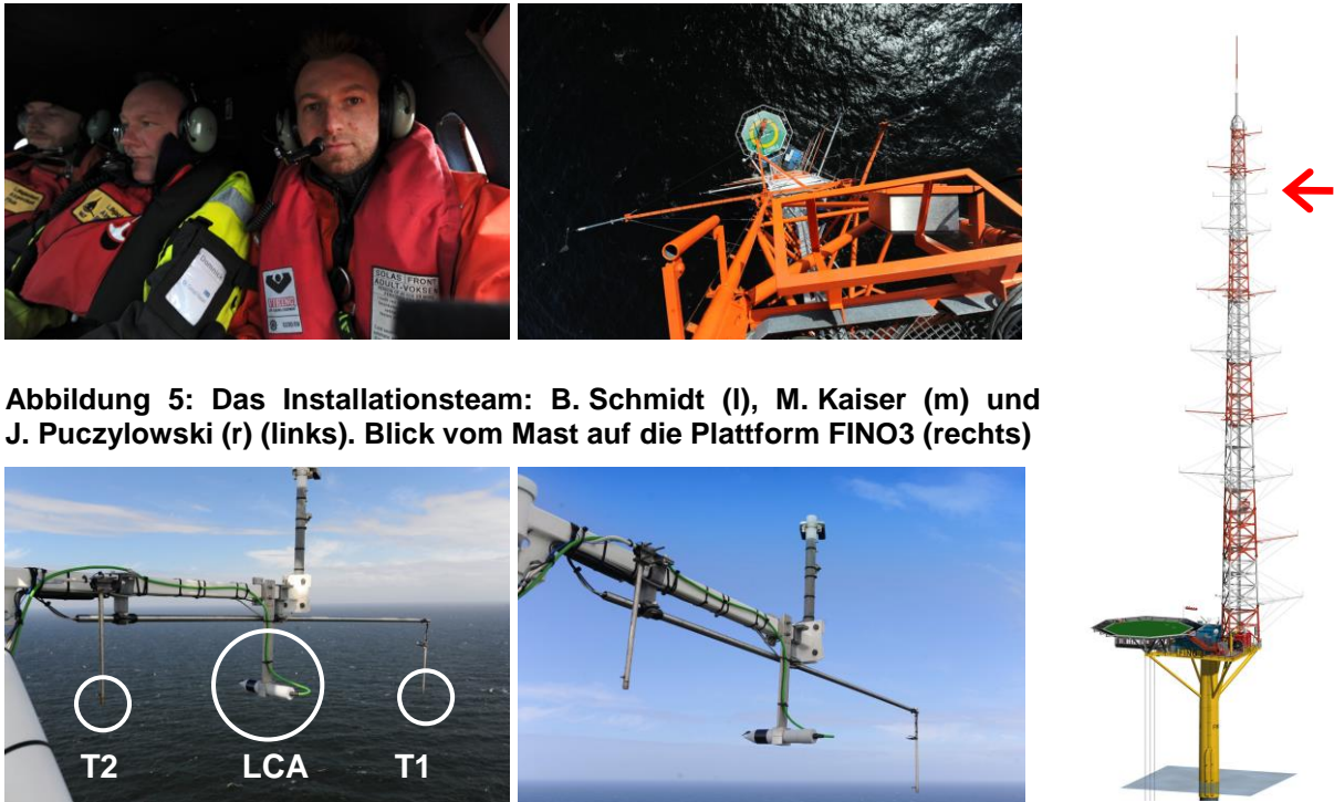
Abbildung 6: Die installierten Sensoren: Das LCA in der Mitte und links und rechts die Piezosensoren T1 und T2 (Bild links & Mitte). Oben ist ein Ultraschallanemometer von GL/GH installiert. Im rechten Bild ist die Station FINO3 skizziert, der rote Pfeil markiert die Lage der Sensoren auf dem Messmast (rechts). Grafik: © Forschungs- und Entwicklungszentrum FH Kiel GmbH
